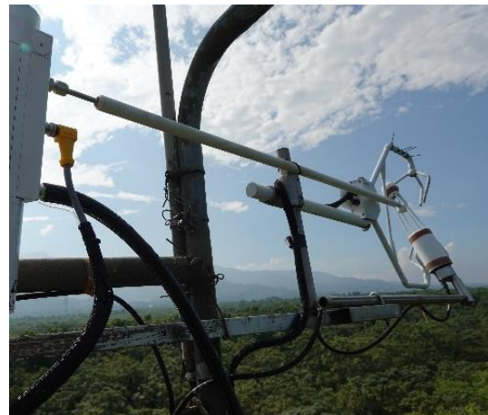
屏東通量站通量觀測設備更換為 LI-7200
